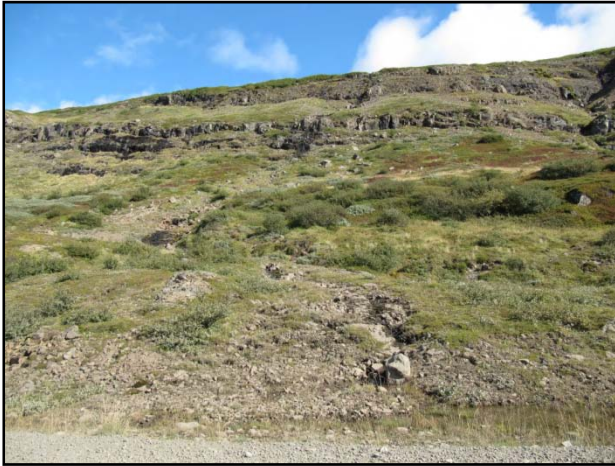
Mynd V.52. Farvegur 54. Lækjarfarvegur oft þurr. Lítil hætta á alvarlegum ofanflóðum, en þó gætu skriður náð að vegi.
